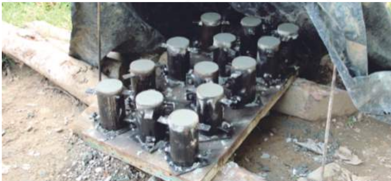
Foto: Cilindros de concreto para ensayo de resistencia a la compresión
